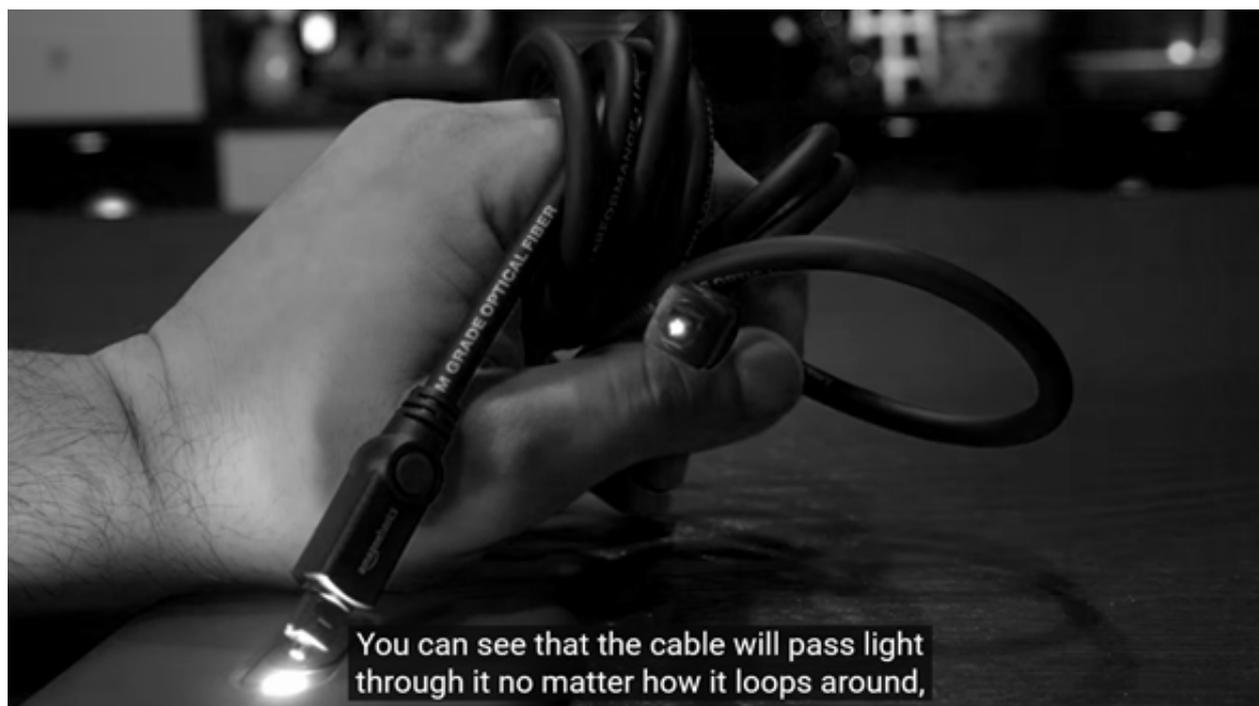
Algo interessante sobre o TOS Link é que, ao contrário da fibra óptica utilizada hoje em dia, ele pode ser dobrado de maneira que não irá interferir na passagem de luz. Seu funcionamento também é bem menos sofisticado, pois no lugar do tubo de vidro ultrafino da fibra óptica atual, o TOS Link possui um tubo de plástico de 1 mm e utiliza LEDs (e não lasers) para fazer o transporte de dados.
